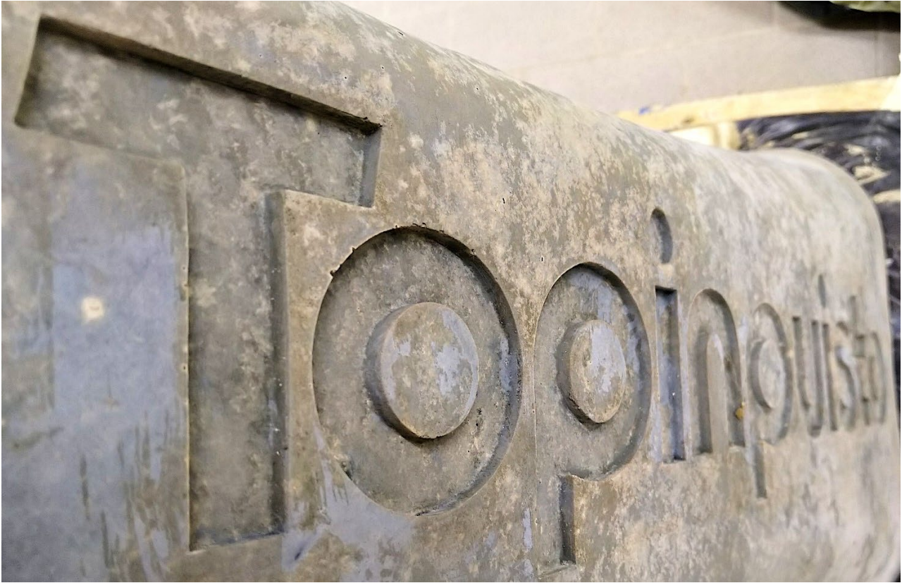
Kuva 3. Yksityiskohta liikenne-esteen logosta ennen pintakäsittelyä
