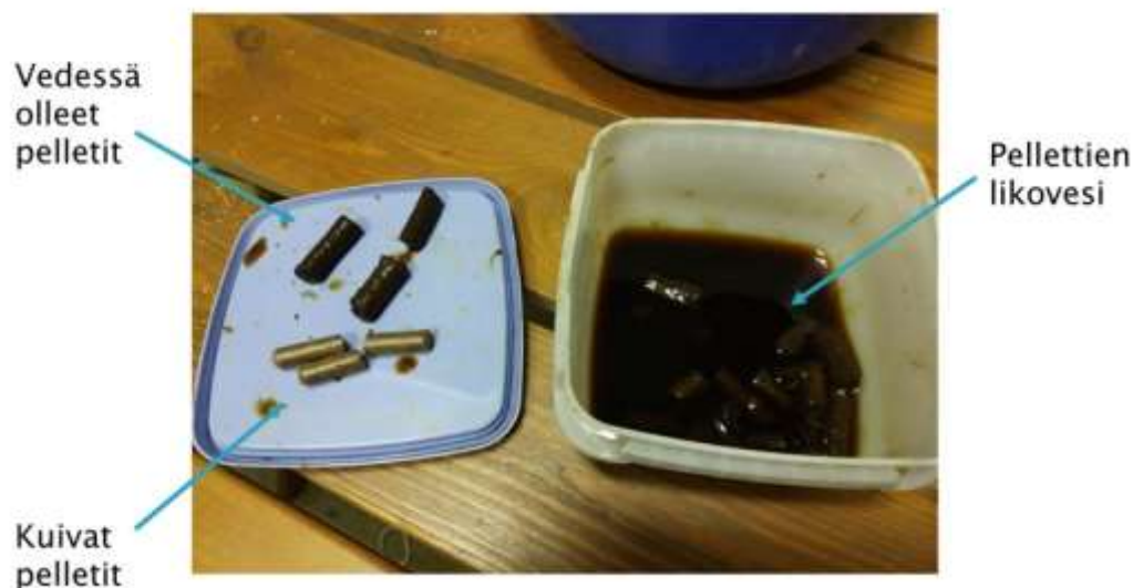
Kuva 3: Ruskeiden pellettien liuotuskoe 07/17 - 02/2019 (jatkuu)
