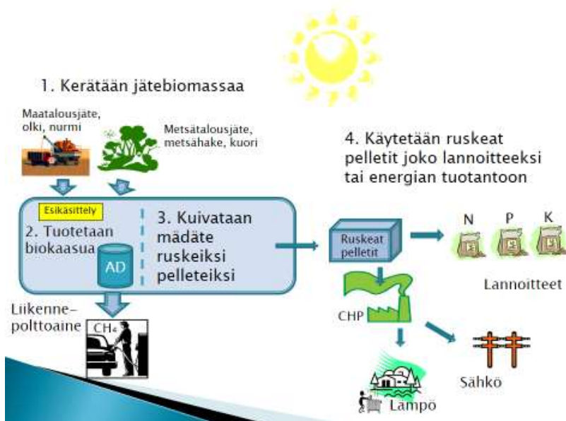
Kuva 1: Ruskeiden pellettien tuotantoprosessi/Finrenes Oy
