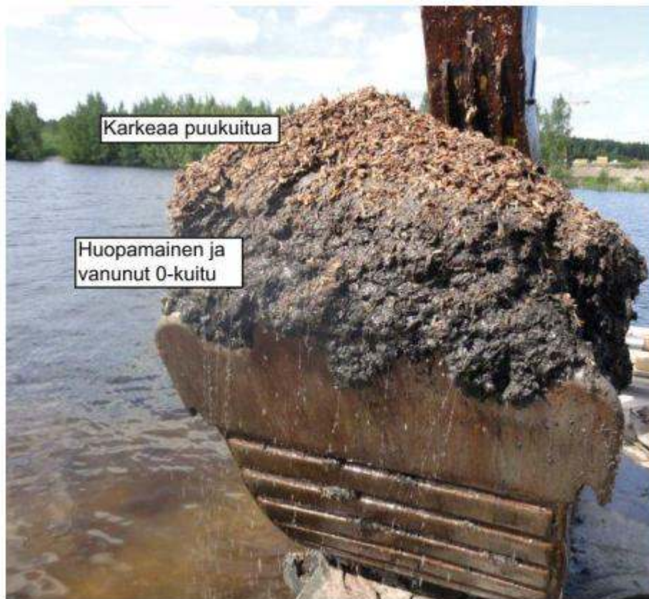
Kuva 4. Nollakuitunäyte, josta näkyy materiaalin luonne ja vaihtelua. (Holopainen 2015)
